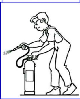
3. Presionar la palanca de la cabeza del extintor realizando una pequeña descarga de comprobación.
