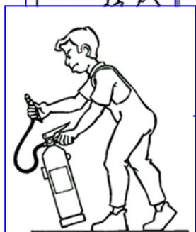
2. Sacar el precinto plástico y la clavija de seguridad tirando de ella. Con una mano tomar el extintor de la manija fija y con la otra tomar el extremo de la manguera.
