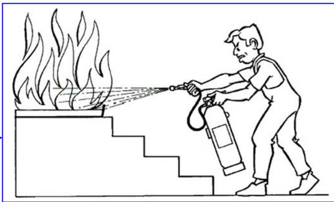
4. Dirigir el chorro a la base de las llamas con movimiento de barrido. En caso de incendio de líquidos aplicar superficialmente el contenido efectuando un barrido evitando que la propia presión de impulsión desplace el líquido incendiado.
